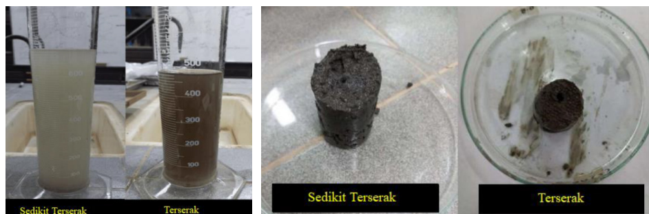
Rajah 9: Efluen spesimen selepas ujian yang menunjukkan perbezaan warna terhadap tahap serakan dan spesimen tanah selepas ujian dijalankan menunjukkan perbezaan lubang jarum bagi tanah tidak terserak dan sederhana terserak.
