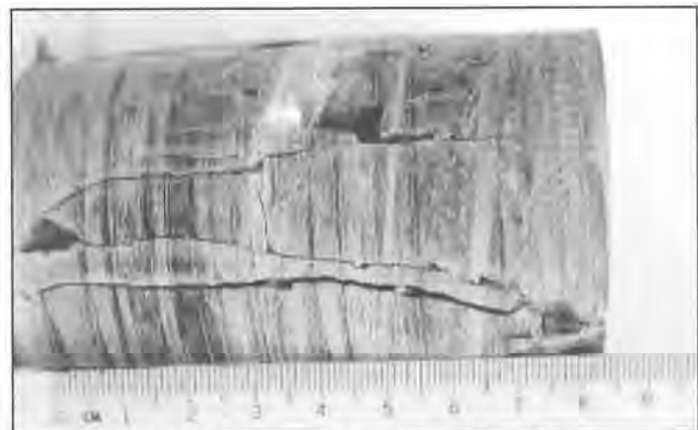
Rajah 5. Kegagalan yang dipengaruhi oleh kehadiran satah ketakselajaran.
