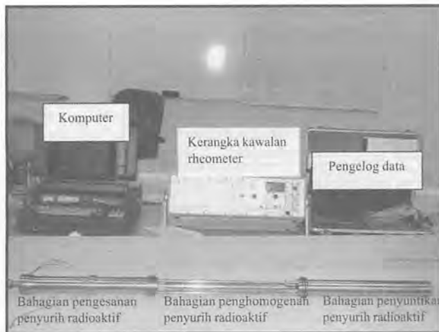
Rajah 1. Sistem rheometer untuk mengukur pergerakan air tanah.
