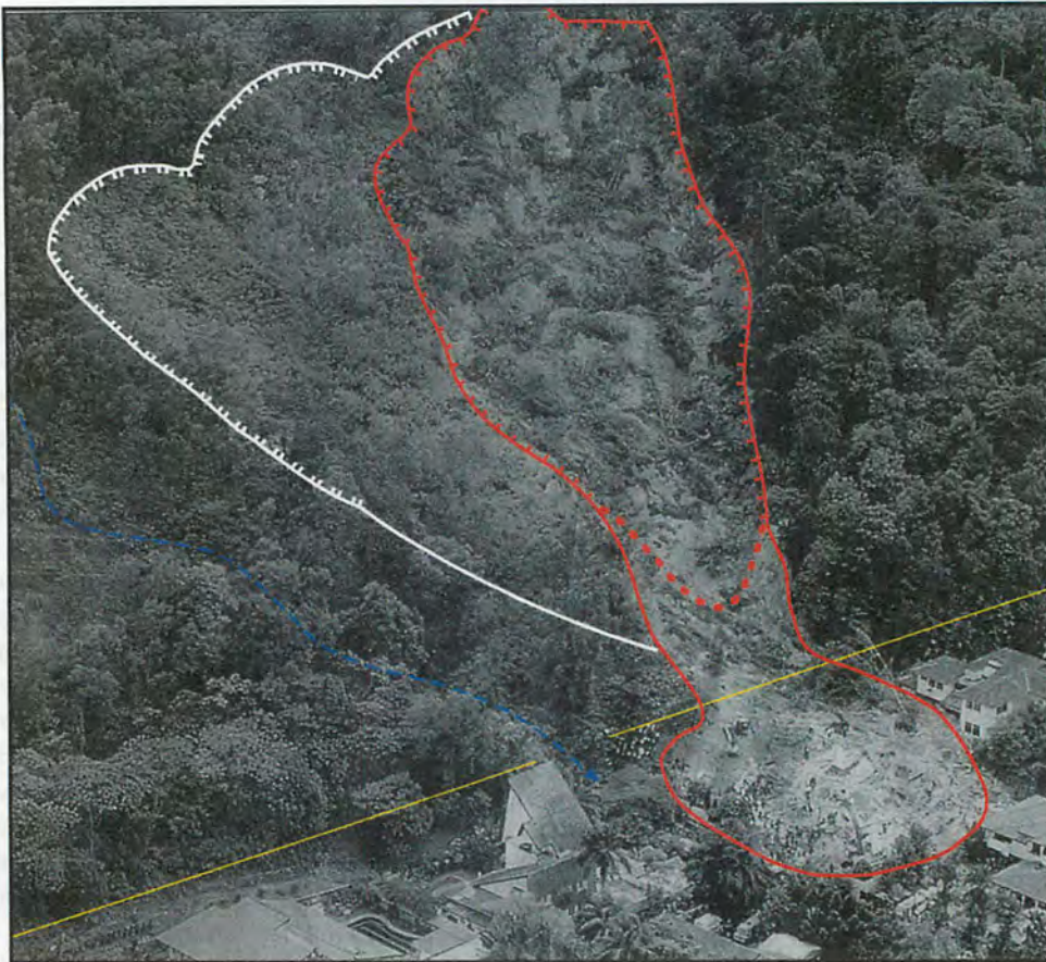
Rajah 6. Fotograf dari udara menunjukkan kedudukan Gelinciran Tanah Taman Hillview di dalam parut gelinciran tanah lama.
