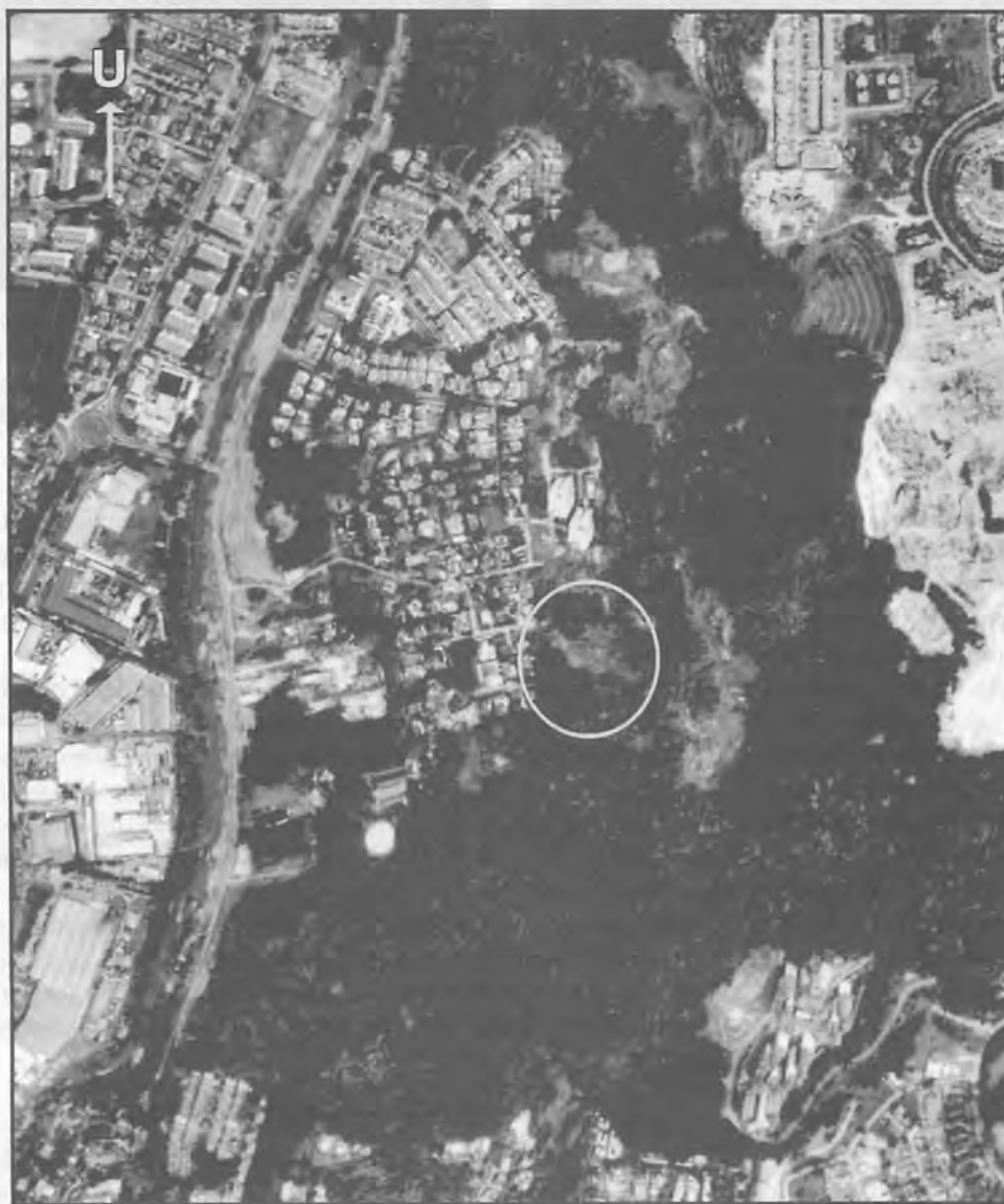
Rajah 3. Fotograf udara bertarikh 8 November 1995 yang diterbitkan oleh Jabatan Ukur dan Pemetaan Negara. Kawasan bertona cerah menunjukkan perataan tapak perumahan yang terbiar di bahagian atas dan kesan gelinciran tanah lama iaitu lokaliti Gelinciran Tanah Taman Hillview.
