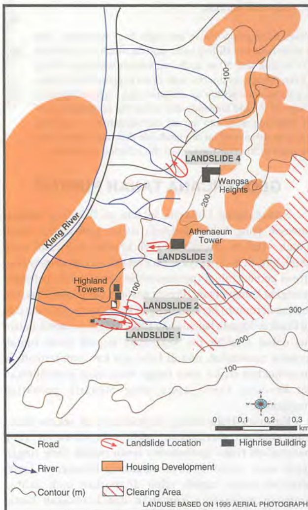
Rajah 1. Kedudukan gelinciran tanah yang pernah berlaku sebelum Gelinciran Tanah Taman Hillview di kawasan Bukit Antarabangsa. Empat gelinciran tanah berada pada satu jajaran berarah sekitar 20° iaitu selari dengan muka cerun dan bersesuaian dengan orientasi lineamen geologi utama di sini.
