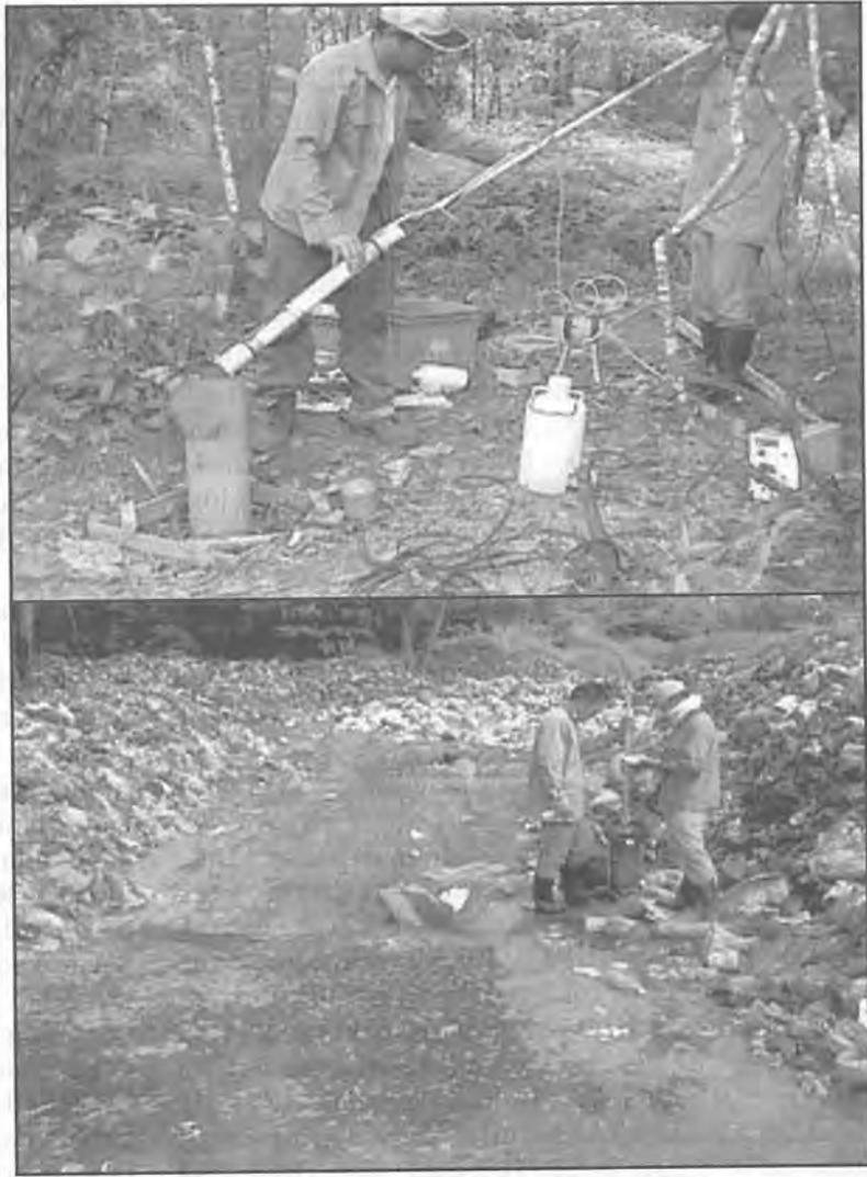
Rajah 4. Menunjukkan alat pengukur arah aliran air tanah.
