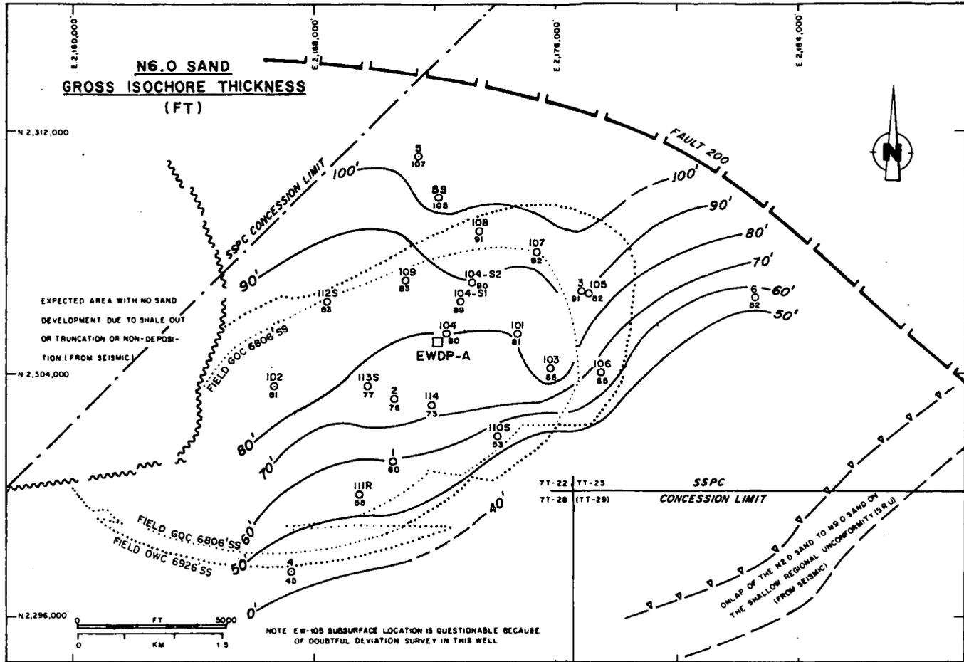
Fig. 18. N6.0 Sand Gross Isochore Thickness
