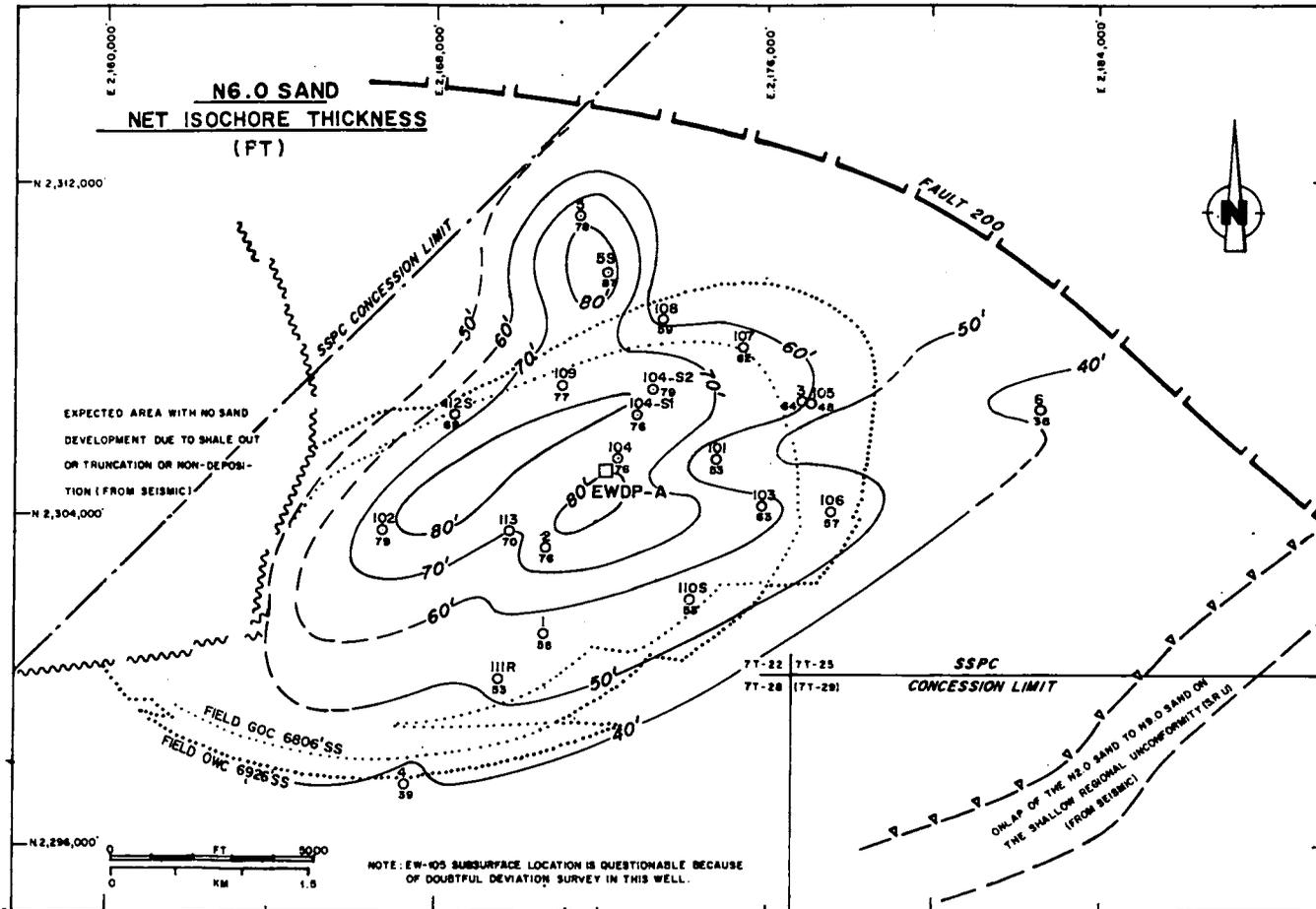
Fig. 19. N6.0 Sand Net Isochore Thickness
