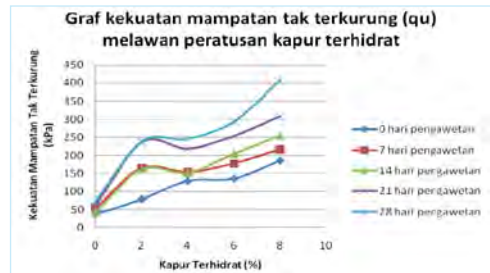
Rajah 5: Menunjukkan kekuatan optima analisis kekuatan mampatan tak terkurung melawan penambahan peratusan kapur terhidrat.
