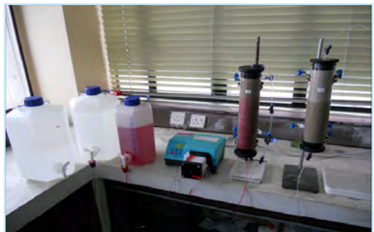
Rajah 1: Gambarfoto eksperimen gelas kolom 1-dimensi di makmal.
