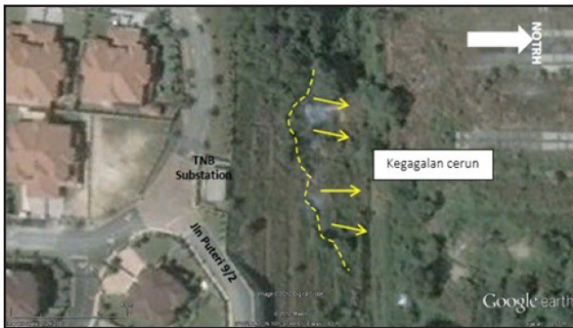
Rajah 8: Pandangan dekat pada lokasi cerun tambahan yang telah mengalami kegagalan cerun.
